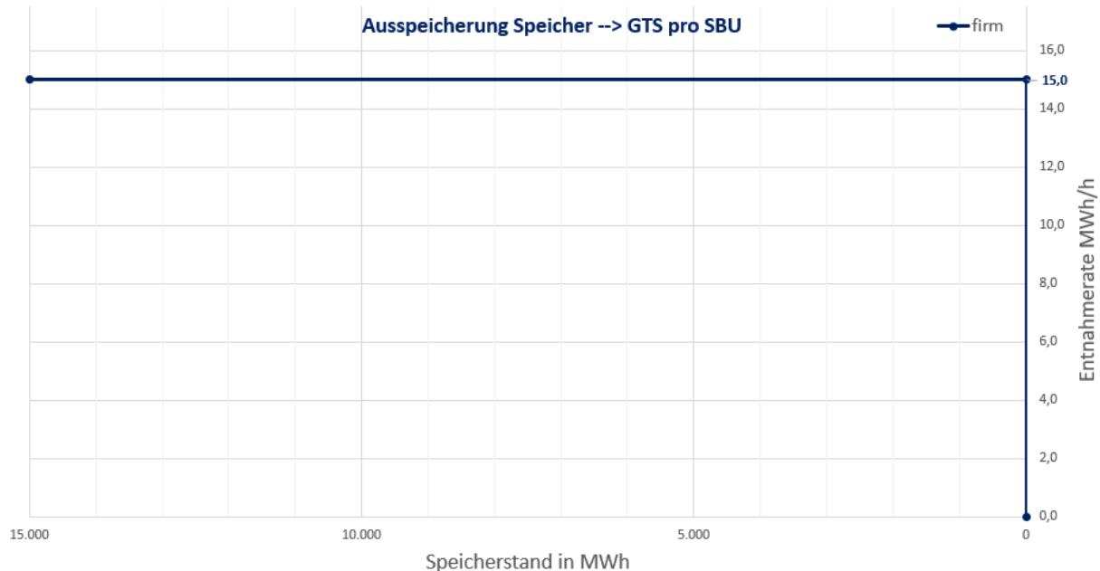
Eine allfällige Reduktion der maximalen Einspeicher- bzw. Entnahmleistung ist vom individuellen **Speicherstand** abhängig.
